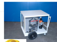
Paineilmanamari, Kompressori, vedenerotin + suodattimet ja letku
